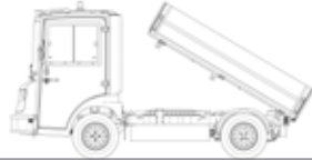
Damperli Alüminyum Açık Kasa E: 1310 x B: 2240 x Y: 440
