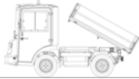
Damperli Alüminyum Açık Kasa E: 1310 x B: 1910 x Y: 440
