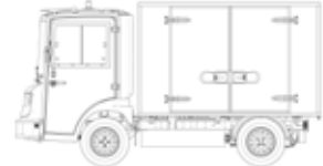
Arka ve Yan Kapaklı Kompozit Kapalı Kasa E: 1320 x B: 2310 x Y: 1350
