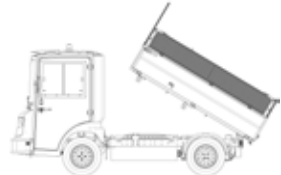
Yükseltilmiş Damperli Çelik Açık Kasa E: 1310 x B: 2240 x Y: 735
